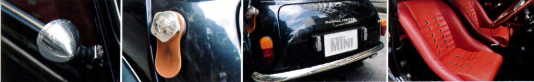
オールドスタイルに定番のパーツと丁寧な板金作業で再現されたMk1のフォルム。真っ赤なバケットシートはコブラシートをベースにカスタマイズされたものだ。
