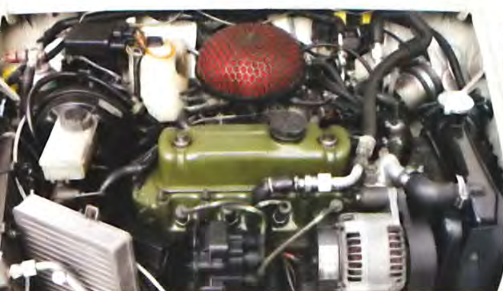
エンジンはシリンダーヘッド研磨が施された1300ccインジェクションに転換。通常はスチールパネルとなるクォーターにガラスがはめ込まれている。
